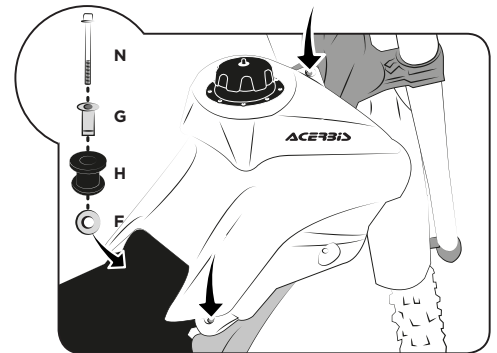
9. Montare serbatoio Acerbis. Mount the Acerbis fuel tank.
